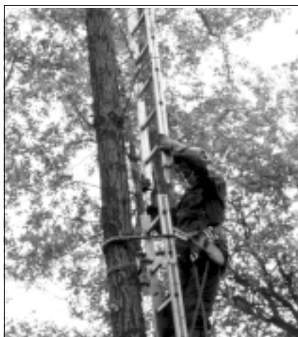
Hochgezogene erste kurze Leiter wird auf die 4,2-m-Leiter aufgesetzt
