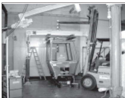
Rops-Test, Längskrafteinwirkung M in (kg)
