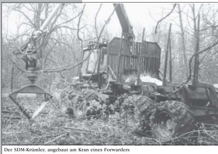
Der SDM-Krümler, angebaut am Kran eines Forwarders
