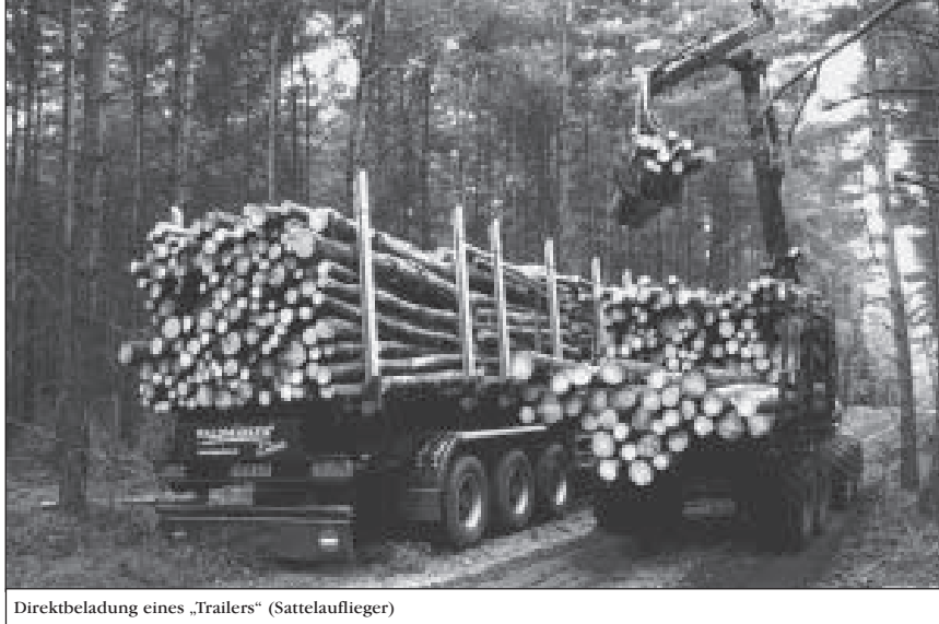
Direktbeladung eines „Trailers“ (Sattelaufzieger)
