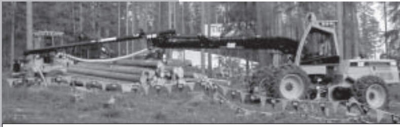
Abb.: Der CAT 550 mit 12,5m-Kran
