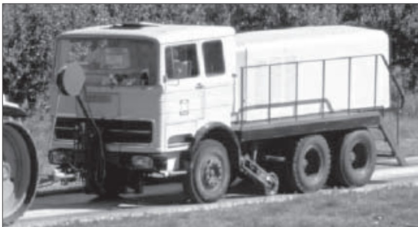
Abb. 5: Zugkraftmesswagen der DLG-Prüfstelle Groß-Umstadt (Bild DLG)
