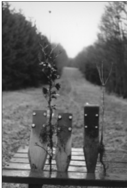
Abb. 2: links zwei Hartmannhauen (Rhodener Verfahren) mit unterschiedlichen Blattbreiten, rechts die Buchenbühler Hacke!
