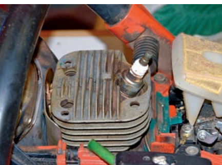
Das Reinigen der Kühlrippen verhindert ein Einbrennen von Schmutz.
