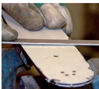
Ein gefeiltes Schwert verschleißt weniger Sägeketten, da die Kette nicht ständig an den feinen Metallwiderständen scheift, die sich beim Sägen automatisch bilden. Das Schwert muß glatt und ohne Fase geschliffen sein.
