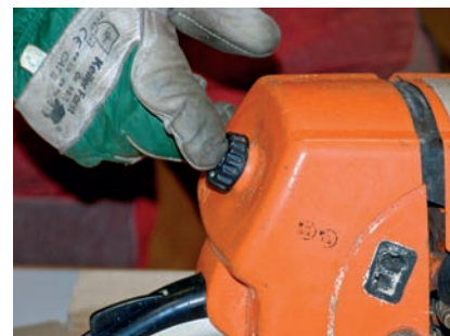
Oben: Das Luftfiltergehäuse ist je nach Hersteller verschraubt oder mit Klemmen beziehungsweise Schnappverschlüssen gesichert.
