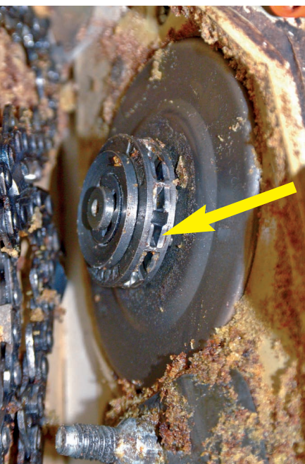
Einlaufspuren am Antriebsritzel können die Sägekette beschädigen. Sind die Spuren über einen Millimeter tief, sollte das Ritzel ausgetauscht werden.
