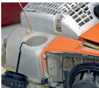
Der Kraftstoffsaugkopf im Benzintank und der Schmiermittelsaugkopf im Öltank können mit einer Drahtschlinge hervorgeholt, begutachtet und gereinigt werden.
