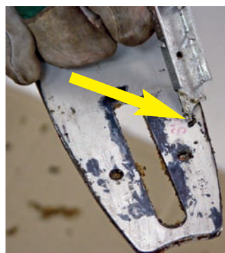
Links: Ein schadhaftes Schwert stellt große Gefahr dar und ist sofort auszutauschen.
