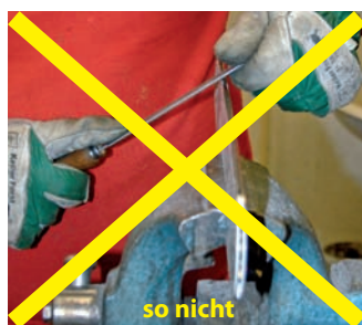
Ein gefeiltes Schwert verschleißt weniger Sägeketten, da die Kette nicht ständig an den feinen Metallwiderständen scheift, die sich beim Sägen automatisch bilden. Das Schwert muß glatt und ohne Fase geschliffen sein.
