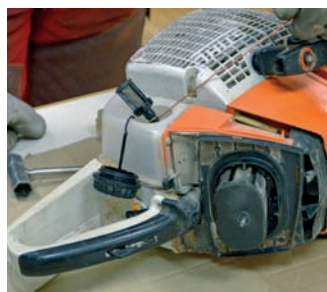
Der Kraftstoffsaugkopf im Benzintank und der Schmiermittelsaugkopf im Öltank können mit einer Drahtschlinge hervorgeholt, begutachtet und gereinigt werden.
