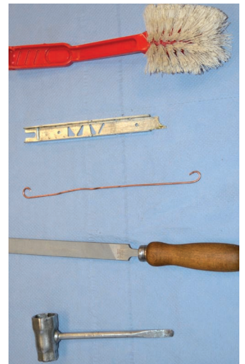
Zur Pflege und Wartung der Motorsäge genügen einige einfache Werkzeuge (v.o.): Bürste, Tiefenbegrenzerlehre, Drahtaken, Flachfeile und Kombischlüssel.
