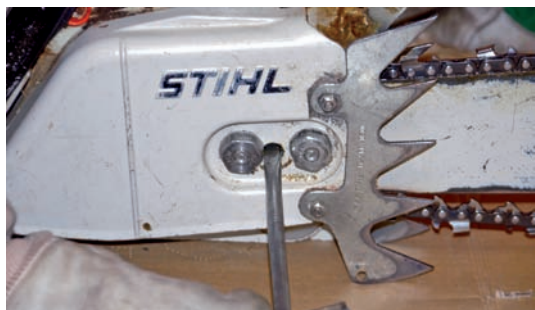
Oben: Vor dem Öffnen des Kettenraddeckels mit einem Kombischlüssel wird der Kettenspannbolzen komplett entspannt.
