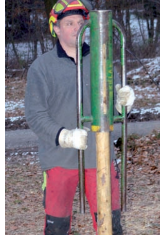
Mit einer Rammkatze lassen sich Zaunpfähle von Hand oder mit Hilfe eines starken Hammers einrammen.
