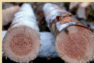
Pfähle aus Lärche (links) und Douglasie (rechts) können 15 Jahre halten.
