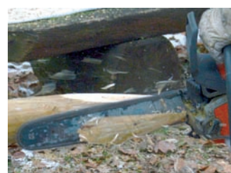
Zaunpfosten lassen sich mit einer Motorsäge am schnellsten anspitzen.
