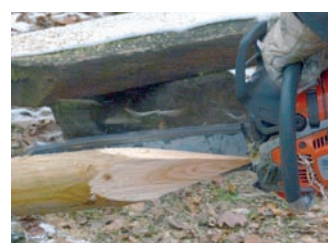
Zaunpfosten lassen sich mit einer Motorsäge am schnellsten anspitzen.
